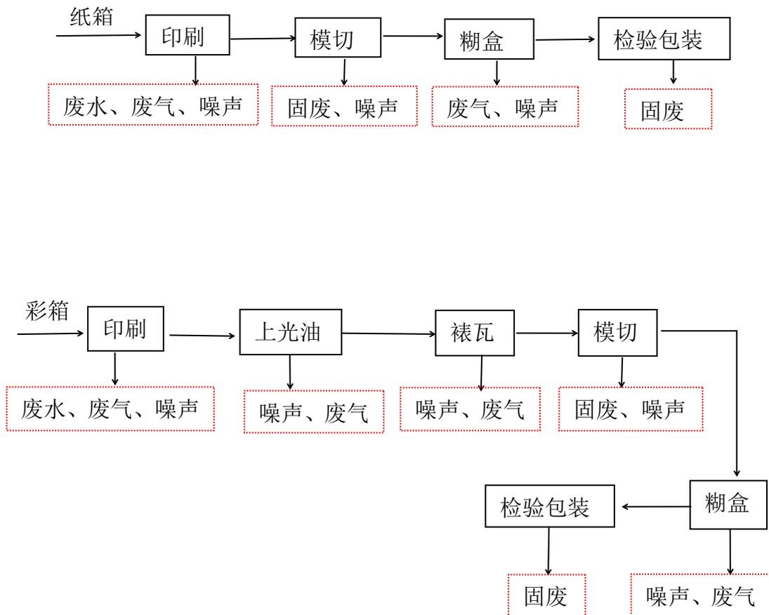
**图 2.3-1 产品工艺流程及产污环节示意图**
