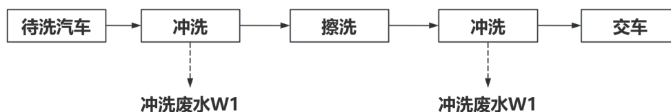
图 2.3-3 项目自动洗车工艺流程示意图
