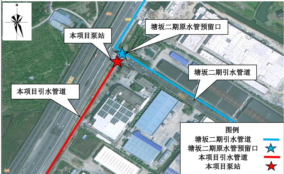
图 1-2 塘坂二期原水管预留口与泵站关系图
