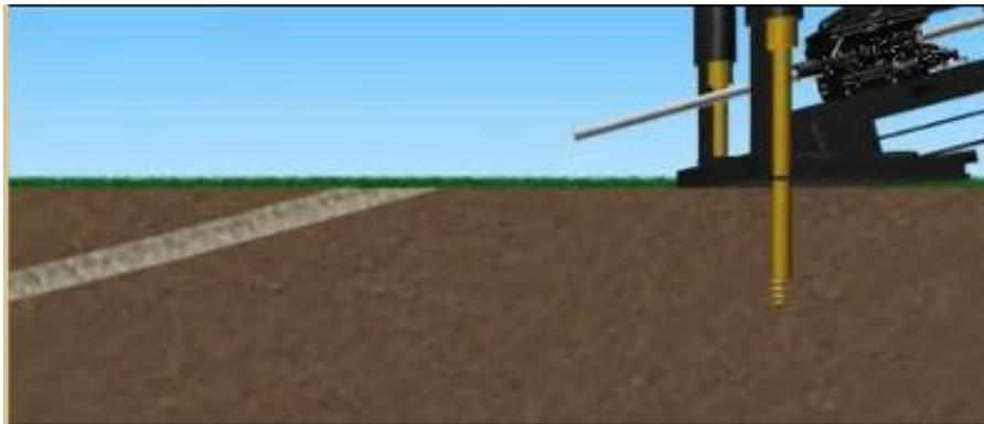
图 2-8 反向拖拉管材示意图
