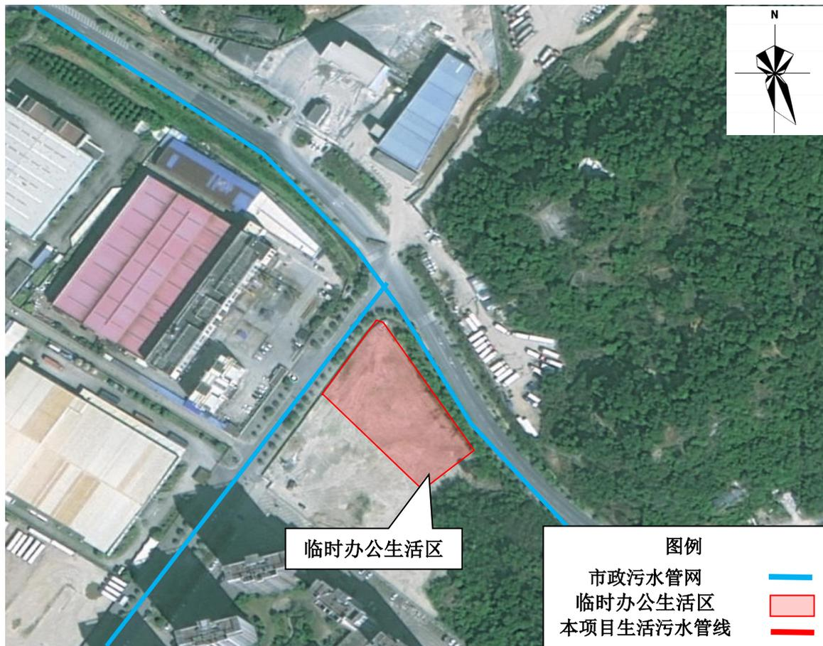
图 4-2 拟接入市政污水管网管网关系图
