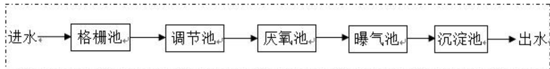
图 4-2 地埋式污水处理工艺流程
