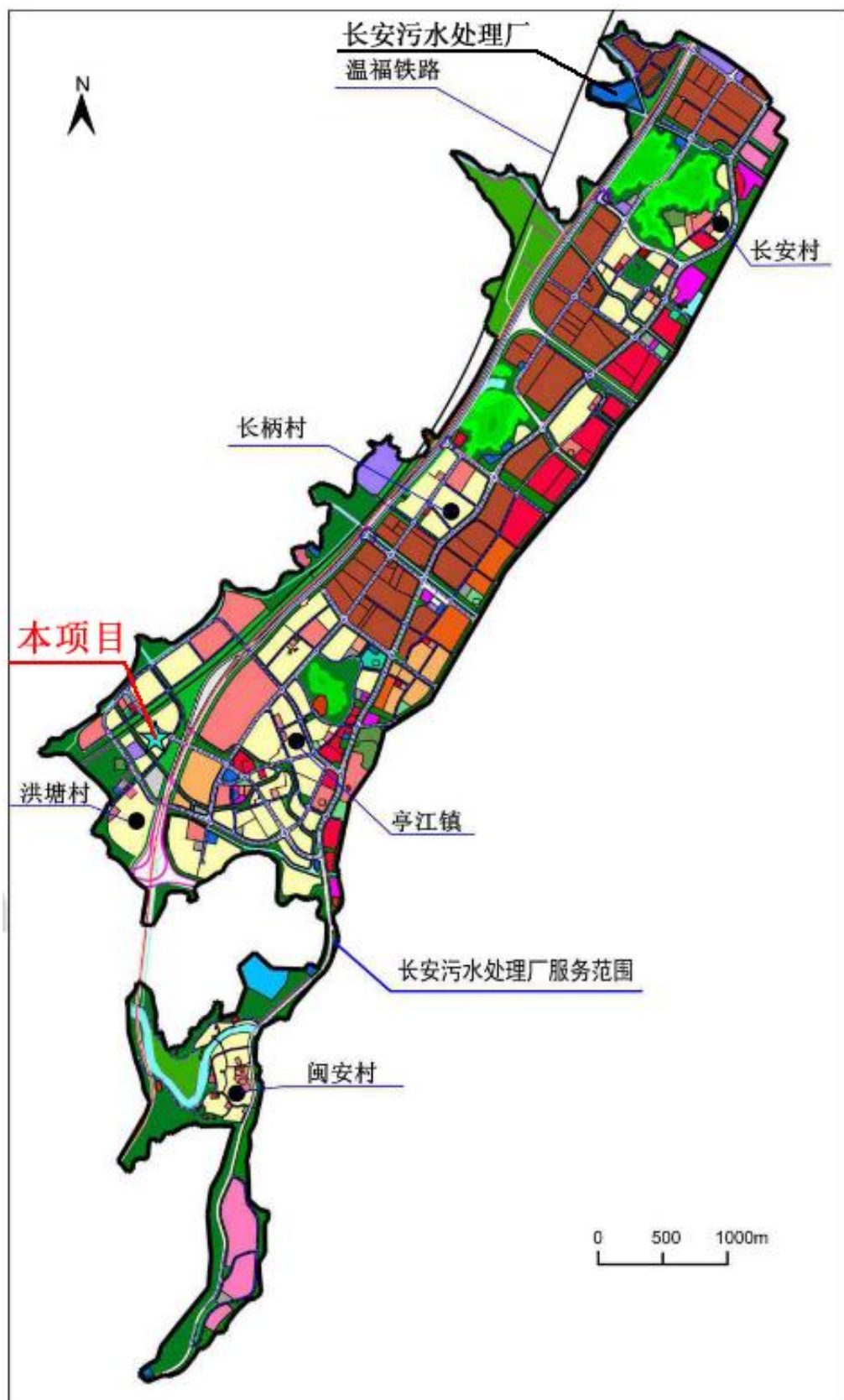
附图 7：长安污水处理厂管网服务范围图
